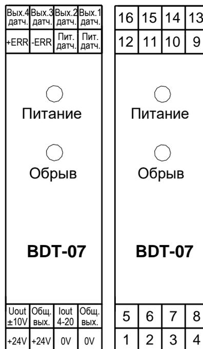
Клеммы 9 и 10 – выходное синусоидальное напряжение возбуждения первичной обмотки.
